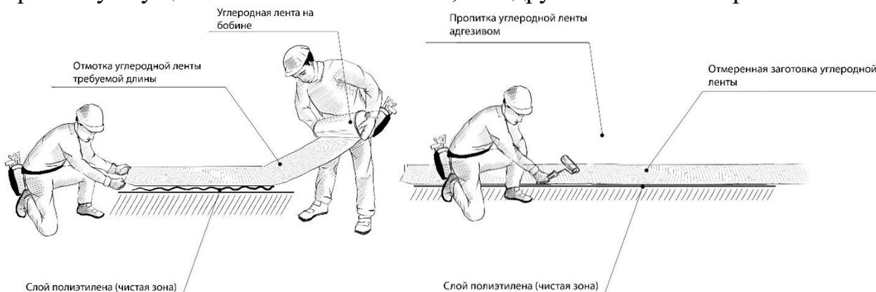
5. Прикатать пропитанную углеродную ленту к поверхности конструкции.
